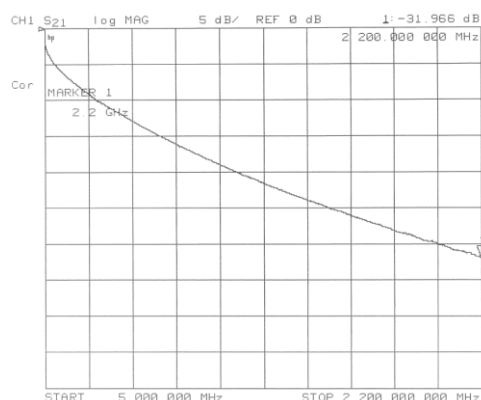
Rysunek 3: Tłumienność kabla NS100TRI
