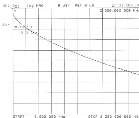
Rysunek 3: Tłumienność kabla NS100TRI
