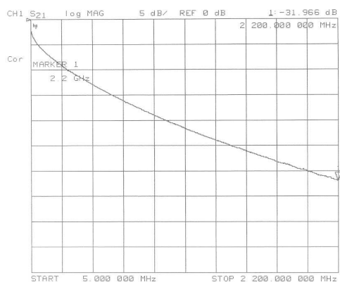
Rysunek 3: Tłumienność kabla NS100TRI
