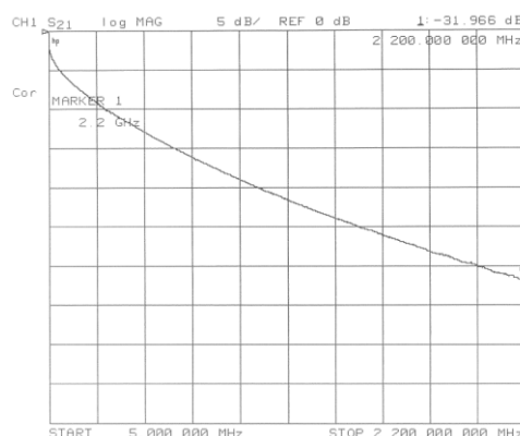
Rysunek 3: Tłumienność kabla NS100TRI
